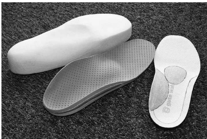
図1 左は整形外科靴技術によるオーダーフットベッドとラスト、右は同技術を使い筆者が開発したフットベッド（グレートヴァール）
